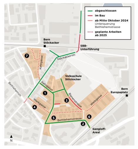
Die Abbildung zeigt die Hauptleitungen für den Fernwärmeausbau. Details wie die Netzanschlüsse zu den Liegenschaften sind nicht abgebildet.
