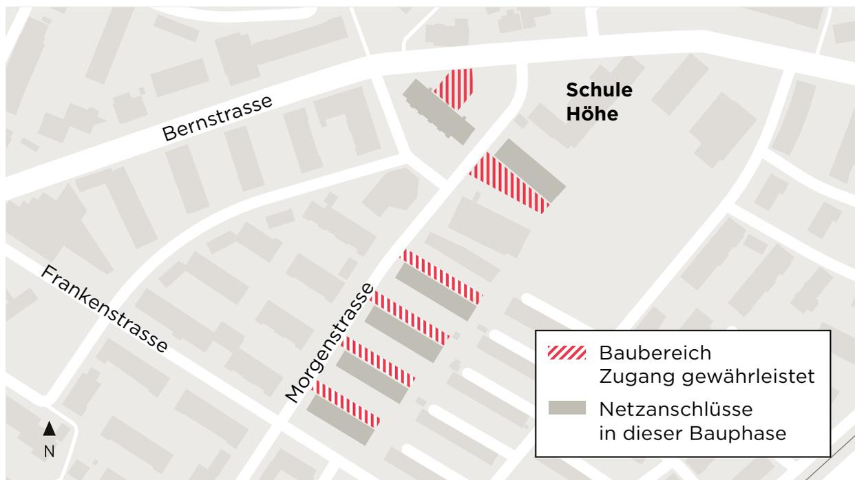
Die nächsten Bauphasen werden parallel mit zwei Bauteams realisiert: Das eine Team startet ab Mitte Januar 2025 mit den Arbeiten an der Fernwärme-Transportleitung in der Stöckackerstrasse in Richtung Bernstrasse. Gleichzeitig realisiert das andere Team in der Morgenstrasse zwischen der Bernstrasse und der Frankenstrasse diverse Netzanschlüsse an den Liegenschaften. In diesem Strassenabschnitt gibt es in dieser Bauphase bis voraussichtlich Ende März 2025 keine Einschränkungen.
